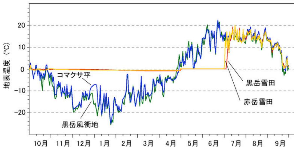
図 3. 2009 年 10 月から 2010 年 9 月までの各プロットの地表面温度の季節変化. 冬季に風衝地土壌は  $-20^{\circ}\text{C}$  以下になるが、雪田土壌は積雪による断熱効果により  $0^{\circ}\text{C}$  に保たれている.
